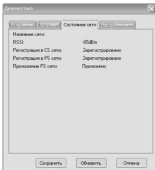
Рисунок 3. Уровень сигнала на модеме при использовании «Connect»
